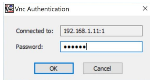
Εικόνα 4- 15: Οθόνη σύνδεσης στο Display 1 στον 192.168.1.11 Linux Fedora Server με VNC από Client σε Windows
