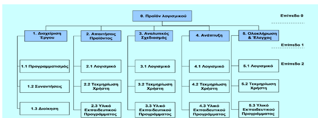
Εικόνα 9: Δομή Ανάλυσης Εργασιών Δείγμα Αναλυτικής Δομής Εργασιών Έργου Πληροφορικής
