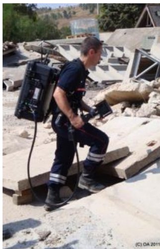
Εικόνα 241 Συσκευή για τον εντοπισμό παγιδευμένων ατόμων στα ερείπια, η οποία παρέχει χημικά σημάδια ζωής, μαζί με ακουστικά και οπτικά δεδομένα (συσκευή FIRST)
