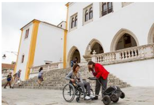
Εικόνα 214 Ηλεκτροκίνητος μηχανισμός που προσαρμόζεται στο αναπηρικό αμαξίδιο, με τη βοήθεια του προσωπικού, για αυτόνομη κίνηση και πρόσβαση του χρήστη σε ελεύθερους χώρους με μεγάλη κλίση ή/και με υλικό επίστρωσης δαπέδου που δημιουργεί δυσκολίες στην κίνηση
