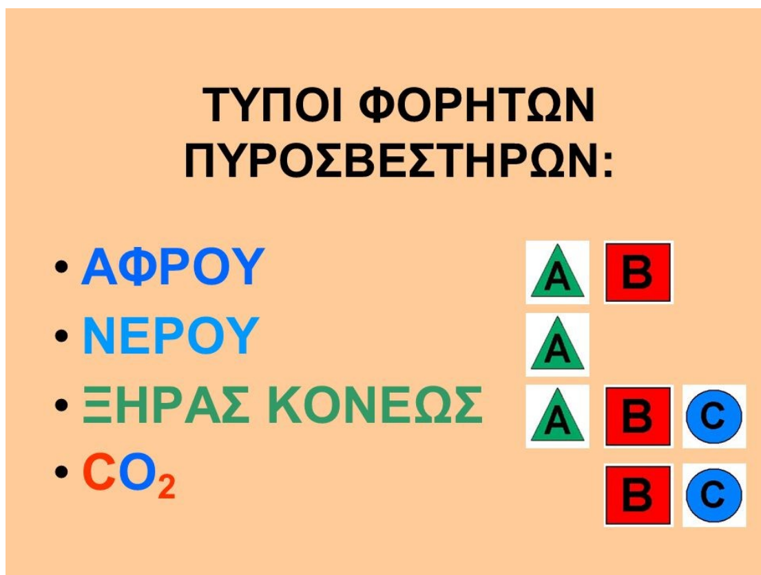
Εικόνα 39. Τύποι φορητών πυροσβεστήρων σε σχέση με το είδος της πυρκαγιάς (πηγή: evoclean.gr )
